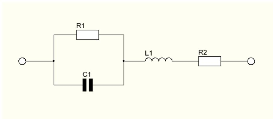
mit  $R_1 = 10\Omega$ ,  $R_2 = 100\Omega$ ,  $C = 70nF$  und  $L = 400mH$ .
