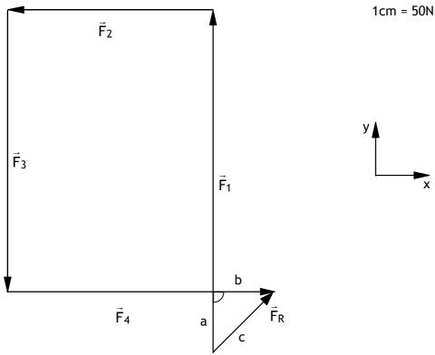
$$\begin{split} \vec{F}_1 + \vec{F}_2 + \vec{F}_3 + \vec{F}_4 &= \vec{F}_R \\ N &\triangleq y; \quad O \triangleq x \\ \begin{pmatrix} 0 \\ 500 \end{pmatrix} + \begin{pmatrix} -300 \\ 0 \end{pmatrix} + \begin{pmatrix} 0 \\ -400 \end{pmatrix} + \begin{pmatrix} x \\ 0 \end{pmatrix} = \begin{pmatrix} a \\ a \end{pmatrix} \end{split}$$
